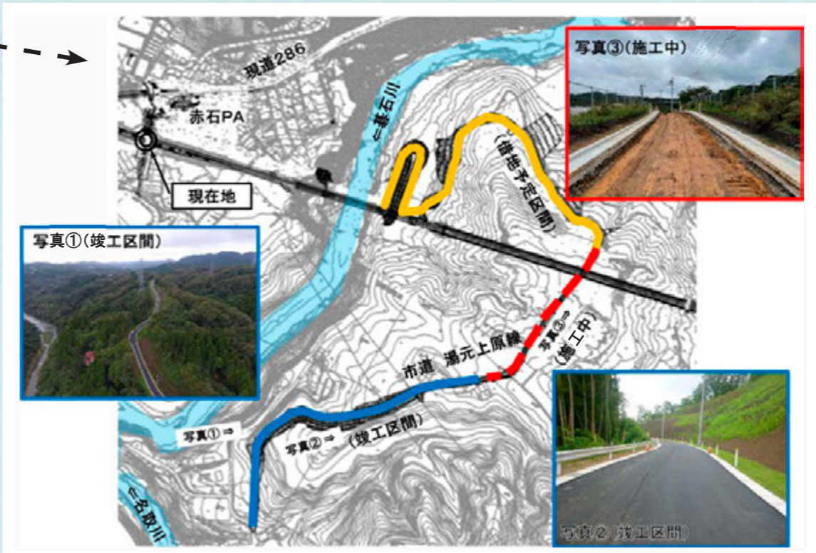
左ページの資料、黄色の線（工事用道路）に注目。上の図は拡大した仙台市分の工事区間です。①は完成した区間を上空より撮影。②は昨年度完成した道路の一部。③は現在、工事の様子です。この事業の特徴は、仙台市と宮城県（川崎町分）がそれぞれ役割を分担し工事を進めていること。
